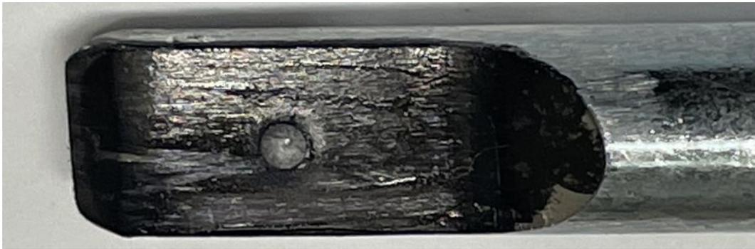
Mit einem 2mm Bohrer durch bohren und ganz leicht ansenken.
