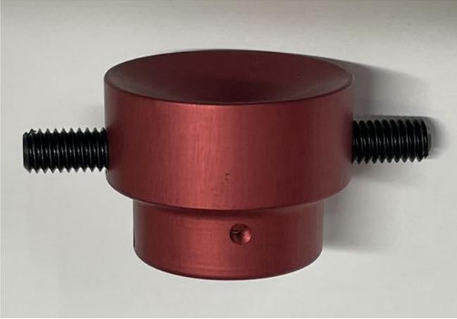
Die Gewinde der Druckstücke gut mit Schraubensicherung-Mittelfest benetzen und wieder eindrehen. Dabei auf Symmetrie achten!
