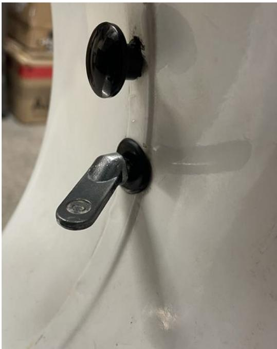
den Hebel mehrmals leicht nach links und rechts drehen und wieder ausfädeln.
