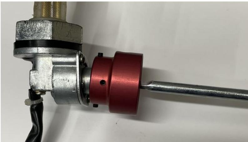
Der Hebel sollte mit einem „Klick“ einrasten und im Adapter fest stecken.
